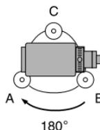
3. **Corrija la mitad del desplazamiento de la burbuja mediante el tornillo C de nivelación del pie.**
