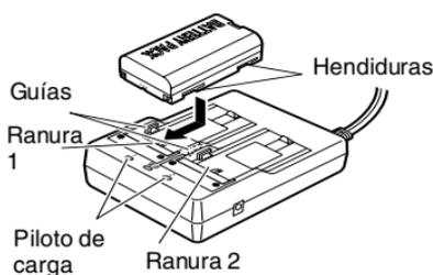
3. La operación de carga dura, aproximadamente, 2 horas. Al terminar la operación de carga, se encenderá el piloto.
