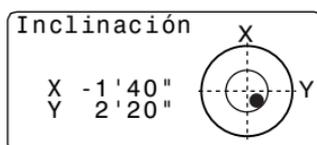
4. Gire el instrumento hasta que el anteojo esté paralelo a una línea entre los tornillos A y B de nivelación del pie y luego apriete la mordaza horizontal.
