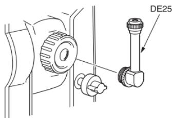
Después de quitar el asa del SET, afloje el tornillo de fijación para retirar el ocular del anteojo. A continuación, atornille la lente diagonal en su sitio.
