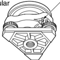
4. **Apriete los tornillos de ajuste hasta que la tensión de los tres tornillos sea igual para alinear la burbuja en medio del círculo.**
