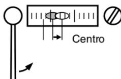
5. **Gire la parte superior del instrumento y siga ajustando hasta que la burbuja siga centrada cuando la parte superior se encuentre en cualquier posición.**
